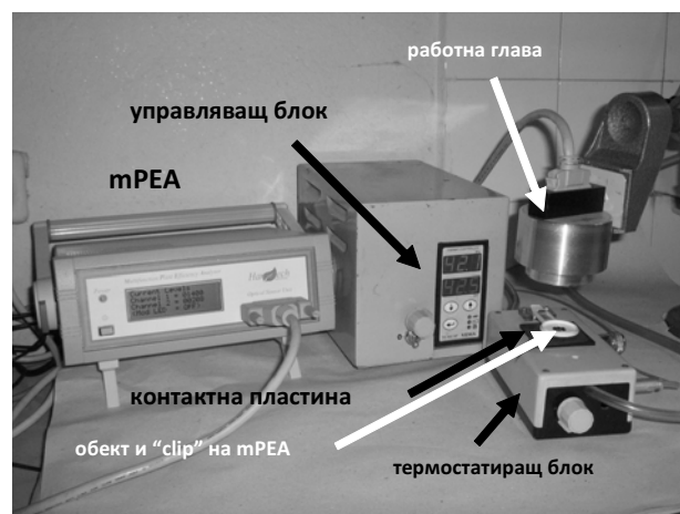
Фиг. 1. Експериментална система за изследване на ефекта на „температурния скок“ върху лист Fig. 1. Experimental setup for investigation of “temperature jump” effects on leaves
