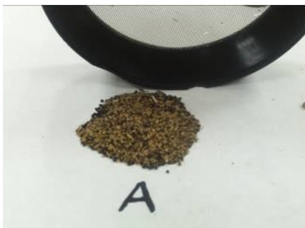
Снимка 2. Фуражна фракция, пресята през лабораторно сито (2 mm) Photo 2. Fodder fraction, screened, using laboratory screen (2 mm)
